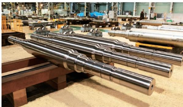
電磁鋼板圧延用ワークロール
