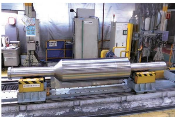
中型自動UT機 (UT: Ultrasonic Testing)
